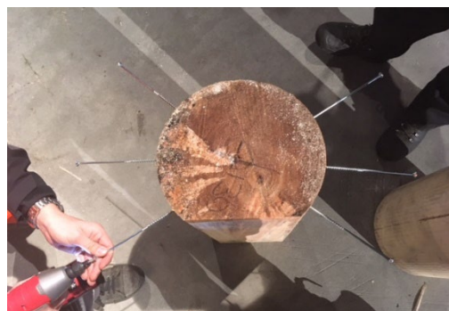
2 Underhand: 3 šrouby zleva a 3 zprava na obou stranách. Celkem 12 šroubů.
